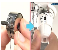
Рис. 1.14 – Схема регулювання величини натягу верхньої та нижньої ниток в швейній машині човникового стібка
