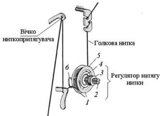
Рис. 1.5 – Траєкторія голкової нитки і конструктивна схема регулятора натягу нитки
