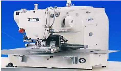
Рис. 6.11 – Напівавтомат фірми «SewQ» SGY2-2010-H-A-20 для пришивання металевих гачків і петель
