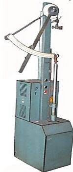
Рис. 2.3 – Машина розривна РМ-3-1 для визначення розривного навантаження та лінійного подовження під час випробування текстильних ниток
