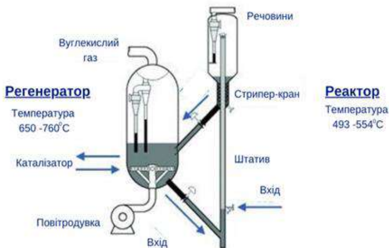
Рис. 2.23. Схематичне зображення процесу флюїдного каталітичного крекінгу
