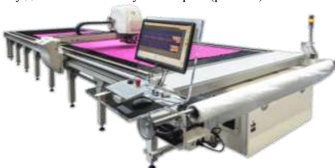
Рис. 6.4 – Зовнішній вигляд автоматичного розкрійного комплексу стаціонарного типу з вакуумною установкою F.K. Group Biliardo 25-60-80 (Італія)
