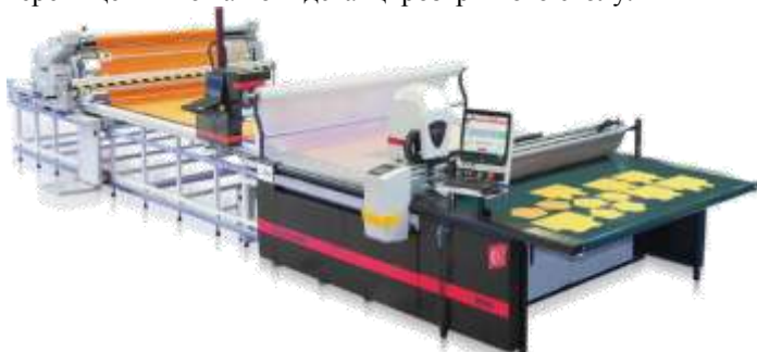
Рис. 6.5 – Автоматичний розкрійний комплекс конвеєрного типу з вакуумною установкою і транспортером для зняття викроєних заготовок Serkon Makina MC 90 (Польща)
