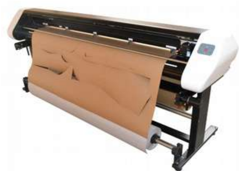
Рис. Г.3. Плотер фірми “Gerber”: a - друк на папері; б — вирізання лекал
