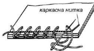
Рис. 3.11 – Утворення петельних стібків при обметуванні петлі
