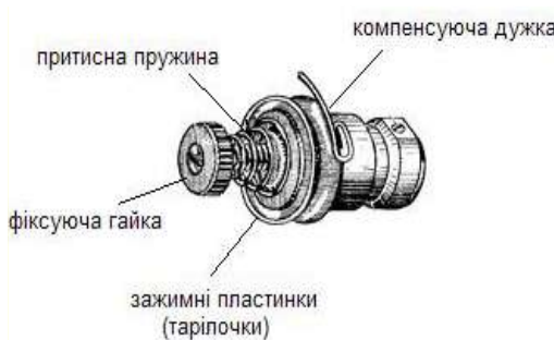
Рис. 5.9. Механізм регулювання натягу верхньої нитки
