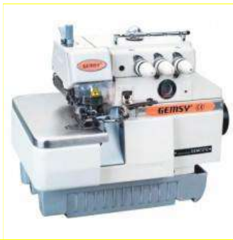
Промислова красобметувальна машина (оверлок)
