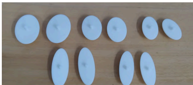
Рис. 2. Накладки, виготовлені за допомогою адитивного виробництва.
