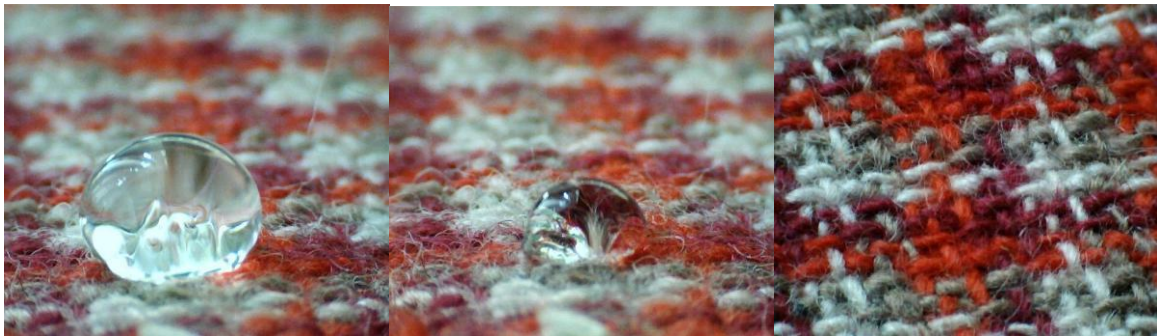
Рис. 2. Процес поглинання крапельно-рідкої вологи
