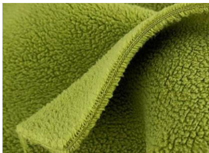
Рис. 1. Будова ворсового начісного трикотажного матеріалу типу «фліс»
