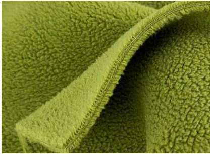
Рис. 1. Будава ворсового начісного трикотажного матеріалу типу «фліс»
