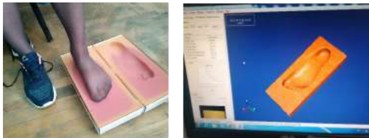
Рис. 1. Сліпок стопи пацієнта та вже відсканована полімерна піна на 3D-сканері
