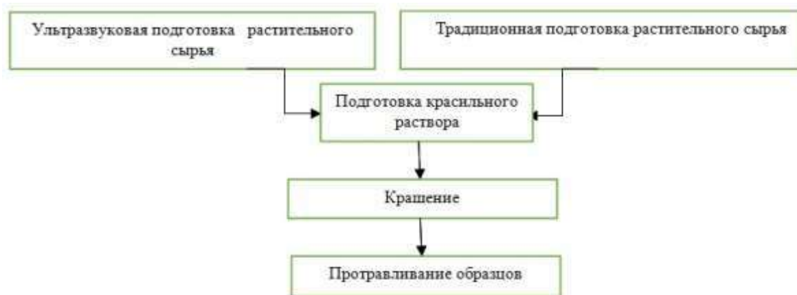
Рис. 1. Технологическая схема процесса крашения природными красителями целлюлозных материалов
