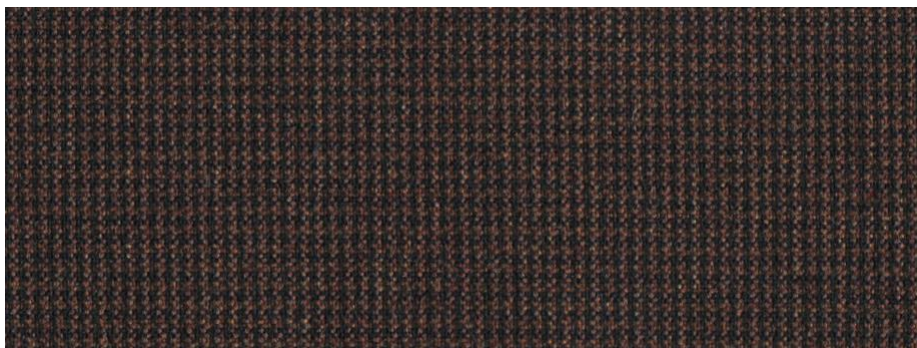
Рис. 5. Зображення проби після 1000 циклів тертя
