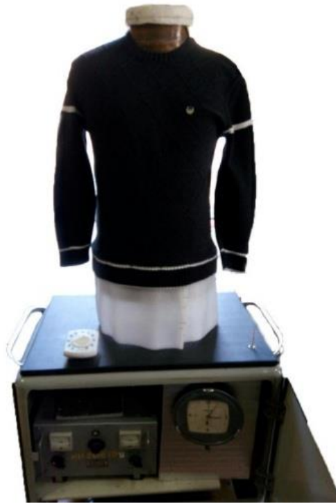
Рис. 2. Імітаційний стенд торсу людини.
